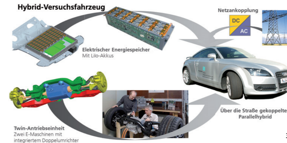
3 Hybridisierter Audi TT: Erprobungsplattform des IISB für leistungselektronische Systemkomponenten.
